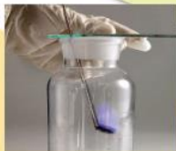
▲ 圖2-2 以廣口瓶收集硫粉燃燒的產物。
